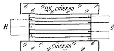
Рис. 20.10. Конструкция диэлектрического узкополосного светофильтра
